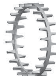
Abb. 8: Einteiliger, gefräster, innenringgeführter Messing-Fingerkäfig.
