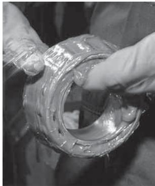
**Abb. 14. Schmierfett kann einfach von Hand aufgetragen werden.**
