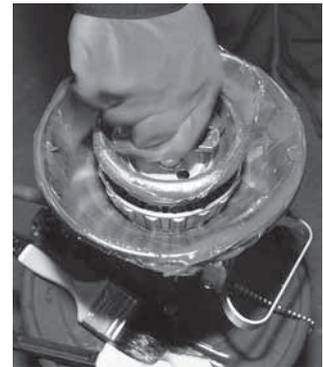
**Abb. 15. Mechanische Schmiervorrichtung**
