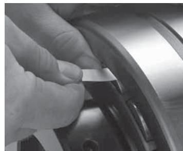
Abb. 18: Messung des RIC vor der Installation.
