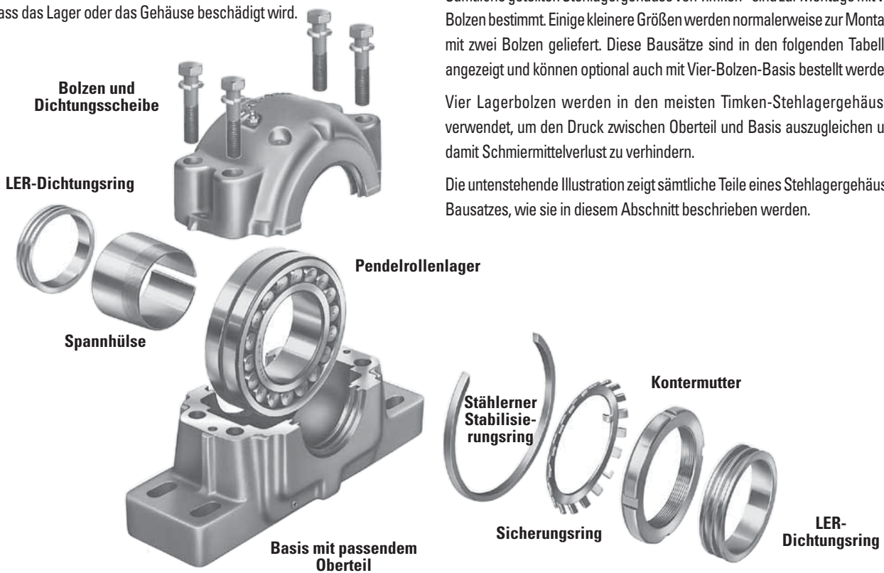
Abb. 26. Explosionsbild eines Timken Stehlagergehäuses mit Pendelrollenlager. Dargestellt sind Pendelrollenlager mit Kegelbohrung, Adapterhülse, Kontermutter und Sicherungsring, Stabilisierungsring und dreifache Labyrinthdichtungen. Außerdem sind Vertiefungen in Oberteil und Basis zu erkennen, die Öffnungen für Hebelwerkzeuge und integrierte Drehöffnungen bieten.
