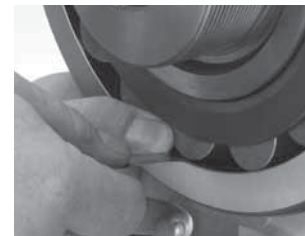
Abb. 15: Während des Einbaus muss das Radialspiels an den nicht belasteten Rollen überprüft werden.
