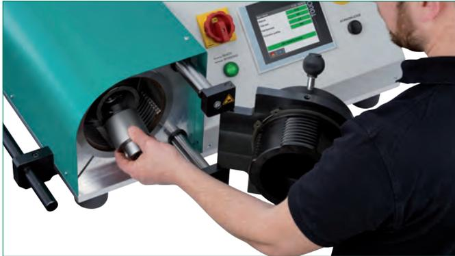
Formstutzen in den Bajonettverschluss der Maschine einsetzen.
