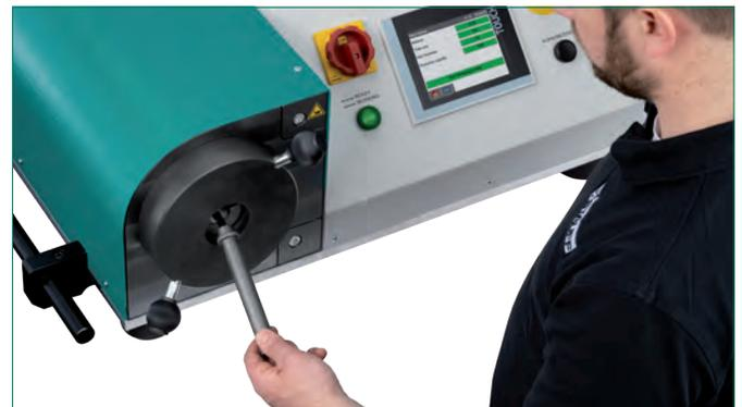
Umgeformtes Rohr entnehmen und visuell überprüfen.
