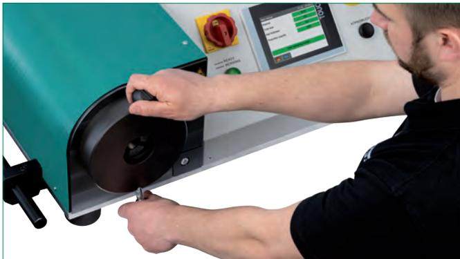
Spannkopf zuschwenken, in die Maschine einschieben und mit beiden Händen per Drehung nach rechts verriegeln.
