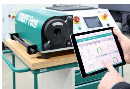
Rohrformmaschinen des Typs SFO-F-A-A können werkseitig mit einem eingebauten Modul zur direkten Anbindung an eine von STAUFF betriebene Cloud ausgerüstet werden. Realisiert wird diese Lösung mit einer integrierten SIM-Karte, die in sämtlichen Industrierregionen der Welt genutzt werden kann.
