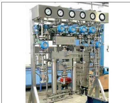
Filterstation für die Filtration von Gasen mit STAUFF 3-Wege-Umschaltkugelhähnen für 250 bar / 3600 PSI und +200 °C / +392 °F.
