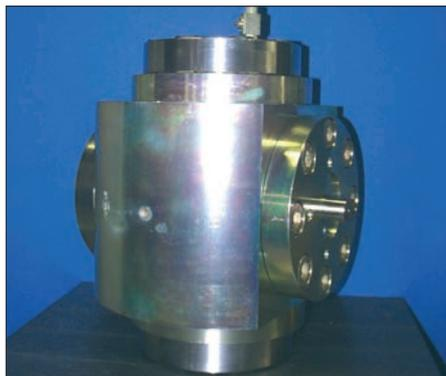
**Kugelhahn für einen Prüfstand: Die Kundenforderung bestand darin, hohen Druck und großes Volumen in kurzer Zeit auf einen Prüfling aufzubringen.**
