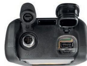
PPC-04-plus-CAN mit CAN-Bus-Schnittstelle für max. 3 Sensoren (max. 50 m / 164 ft Kabellänge)
