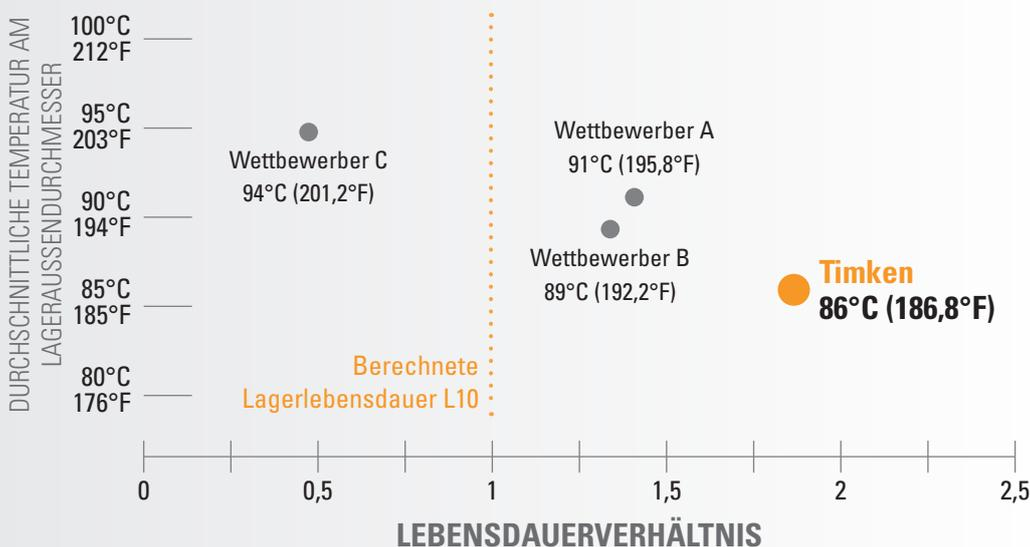
Geprüft wurde das Lager 22212 bei 2700 Umin<sup>-1</sup> mit einer Last von ~25 % der dynamischen Tragfähigkeit.
