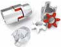
Nutzen Sie die Vorteile einer kompakten Konstruktion, die ausgelegt ist, um radiale Fluchtungsfehler und Winkelversatz der beiden verbundenen Wellen zu kompensieren. Flexible SPIDEX®-Klauenkupplungen von Lovejoy® dämpfen Stoßlasten und Torsionsschwingungen im Antriebsstrang.
