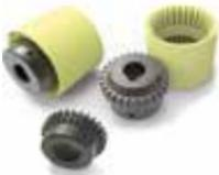
Kompensieren radiale, winklige und axiale Fluchtungsfehler der Welle. Diese Zahnkupplungen mit Naben aus Stahl und innenverzahnter Nylonhülse besitzen eine Kupplungshülse aus Polyamid mit Gleiteigenschaften, die die Auswirkungen von Stoßlasten verringert.
