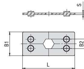
Aus flammhemmendem Kunststoff PPV0 gefertigt; geprüft und V0-klassifiziert entsprechend UL94
