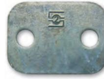
Original STAUFF Deckplatte mit Zink/Nickel-Beschichtung: Keine Anzeichen von Korrosion nach **1200 Stunden** in der Salzsprühnebelkammer!
