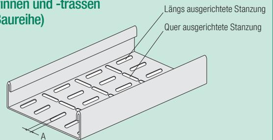
ACT-Hammerkopfschrauben eignen sich für gängige Kabeltrassen und -rinnen mit einer diagonal, längs oder quer ausgerichtetem Stanzung, die folgenden Kriterien erfüllen:
