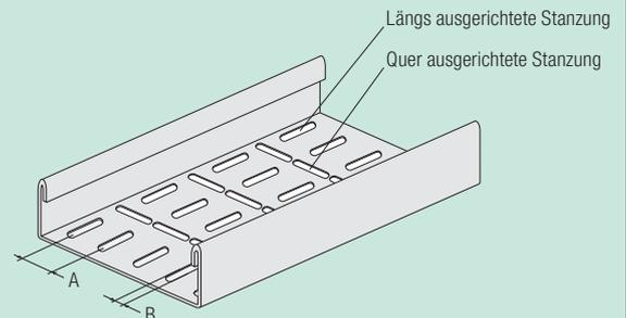
ACT-Hammerkopfschrauben eignen sich für gängige Kabeltrassen und -rinnen mit einer diagonal, längs oder quer ausgerichteten Stanzung, die folgenden Kriterien erfüllen:
