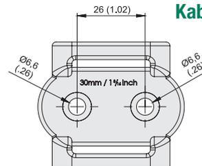
**Kabelbinder- / Spanngurt-Schelle
