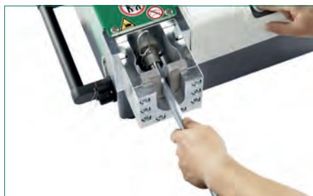
Werkzeugkopf zur Schneidring-Montage mit manueller Druckeinstellung
