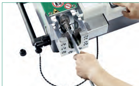
Werkzeugkopf zur Schneidring-Montage mit automatischer Druckeinstellung / Größenerkennung
