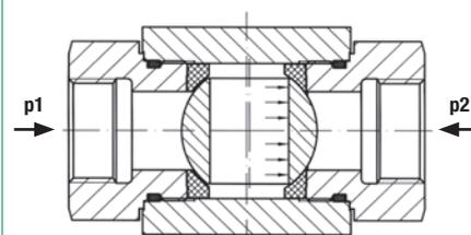
Der Kugelhahn hat eine schwimmende Kugel.
