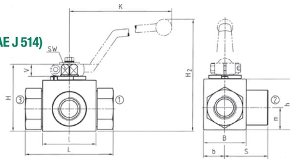
Ab DN32, STAUFF Größe 20 aus einem Block gefertigt
