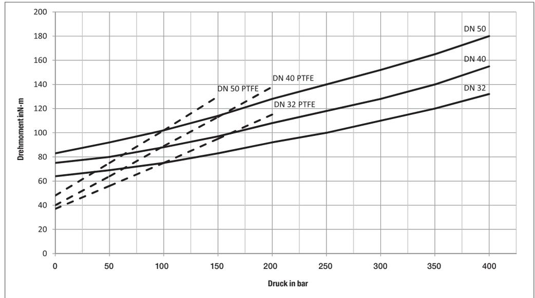
Schaltdrehmoment von Kugelhähnen
