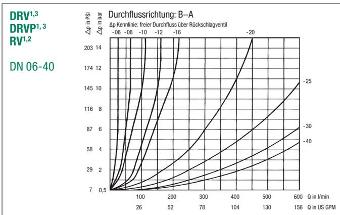
Bitte beachten Sie: Die an dieser Seite dargestellten Kennlinien gelten für Mineralöle mit einer Dichte von 0,86 kg/dm<sup>3</sup> und der kinematischen Viskosität 35 mm<sup>2</sup>/s (35 cSt).
