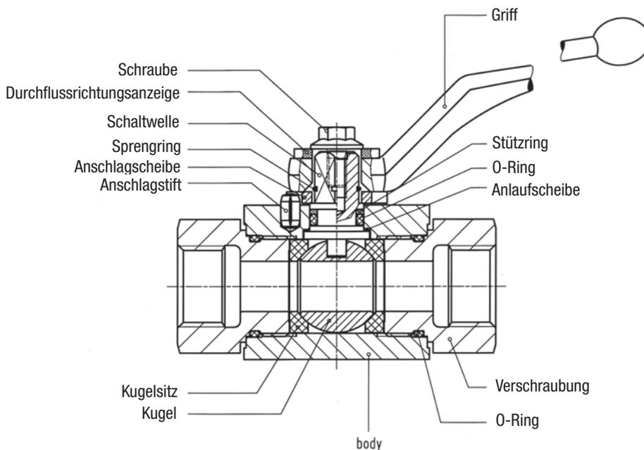
Die Montage hat so zu erfolgen, dass die Kerbe der Schaltwelle mit der Kerbe der Scheibe richtungsidentisch ist.
