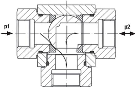
Der Umschaltkugelhahn hat 2 Dichtungen und eine schwimmende Kugel.
