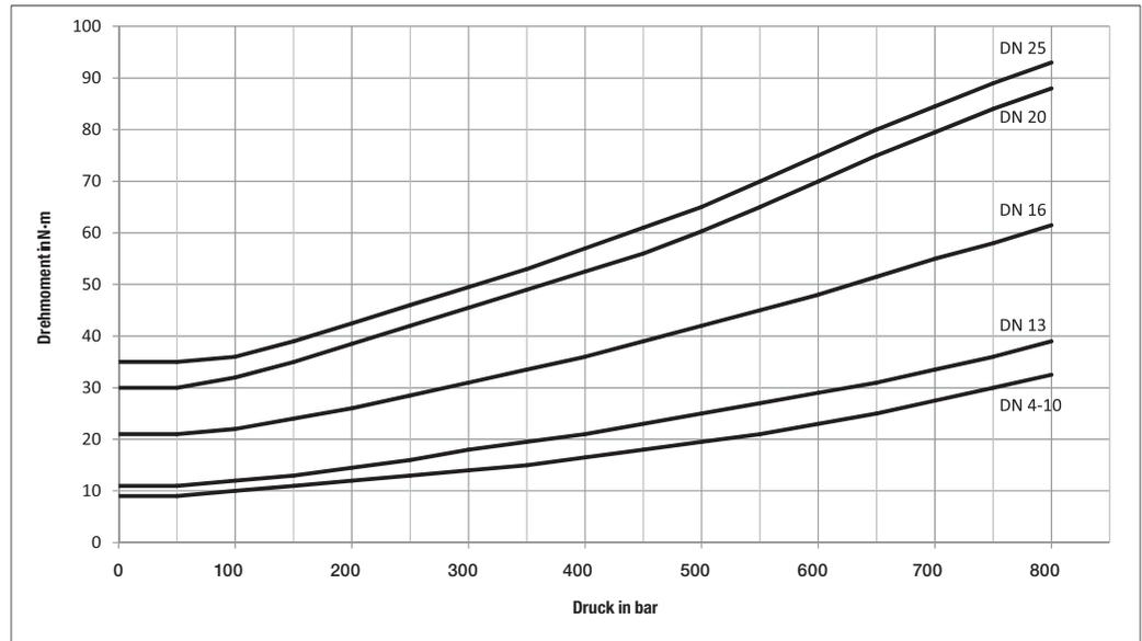
Schaltdrehmoment von Kugelhähnen
