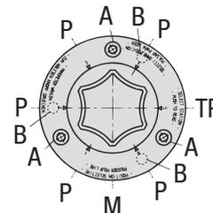
**Befestigungsbohrungen** ( $\varnothing 6$  mm / .24 in)
