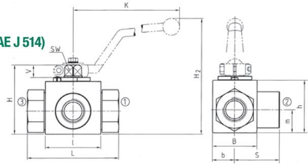
Ab DN32, STAUFF Größe 20 aus einem Block gefertigt
