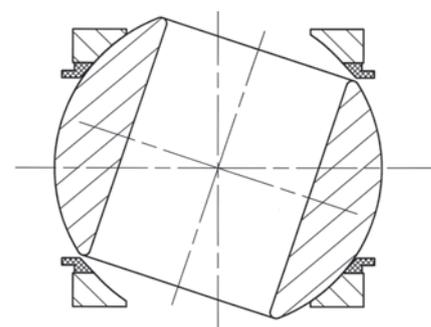
Der Ring aus speziellem Werkstoff schützt die Dichtung vor Erosion
