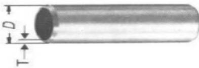
Präzisions-Stahlrohr DIN EN 10305-3 geschweißt, blank geglüht, galvanisch verzinkt min. 10 µm, Cr<sub>6</sub> frei passiviert silberfarben transparent, in Längen von 5-6m.
