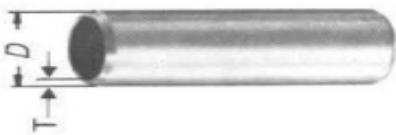
Präzisions-Edelstahlrohr DIN DIN EN 10217-7 bzw. DIN EN ISO 1127 geschweisst, kalibriert, blank gegläht, in Längen von 5-6m.
