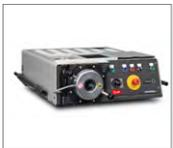
Dazu die Werkzeuge in die Maschine einsetzen und Werkzeuge in die Einlegeposition fahren. Rohrende bis zum deutlich spürbaren Anschlag im Grund des Formstutzens in die Maschine einführen. Rohr gegenhalten und Umformprozess starten. Der Umformprozess läuft automatisch ab. Bedienungsanleitung der Walform-Maschine beachten.
