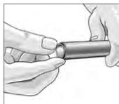
3. Einsteckhülse bis zur Rändelung in das Rohr einstecken.
