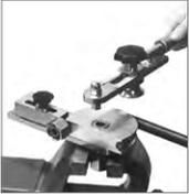
7. Zum Herausnehmen des Rohrbogens Gegenhalter lösen. Rohrbogen herausnehmen, bei komplizierten Biegeformen eventuell Hebelvorrichtung und Biegerolle entfernen.
