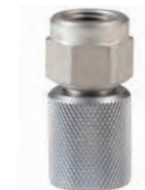
SMD-20-1/4NPT-W3 Adapter für Prozessanschluss 1/4NPT (N04) auf Messkupplung STAUFF Test 20 (Adaptionsgewinde M16 x 2) Maßzeichnung: Alle Abmessungen in mm (in).
