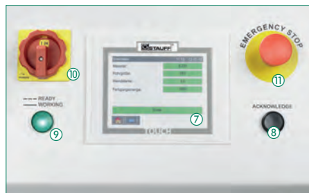
Bedienbereich der Rohrumformmaschine
