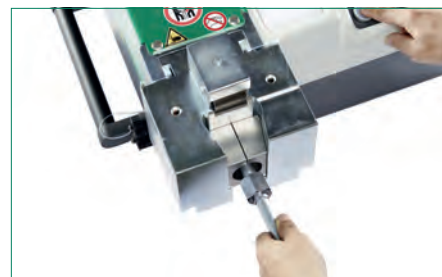
Werkzeugkopf zum 37°-Bördeln mit manueller Druckeinstellung
