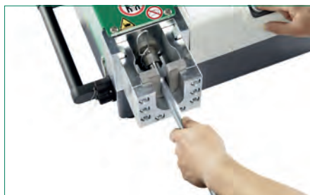
Werkzeugkopf zur Schneidring-Montage mit manueller Druckeinstellung
